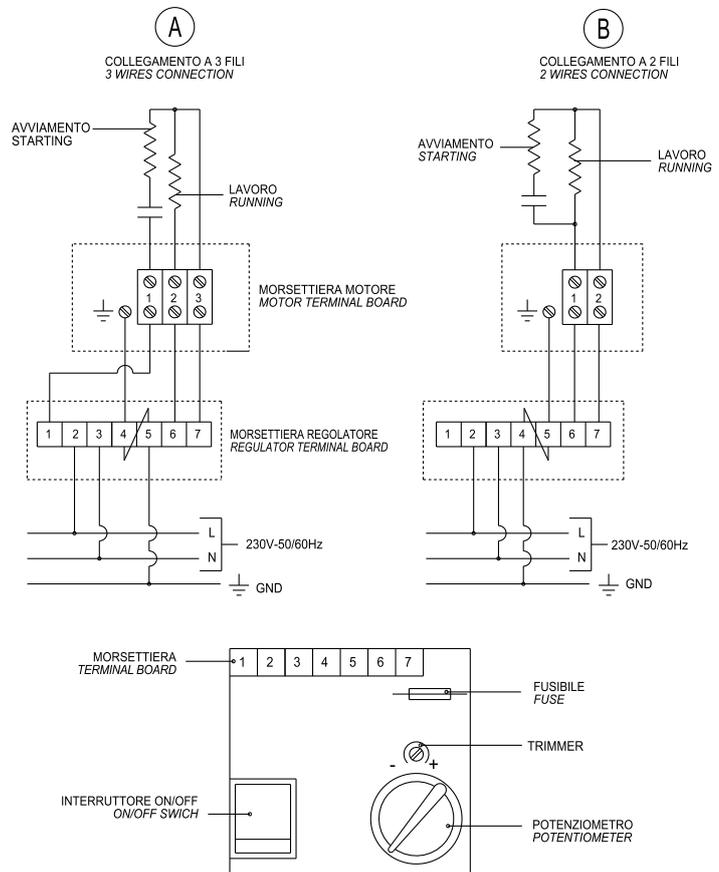
NB.: per ottenere una regolazione ottimale utilizzare il collegamento (A).
